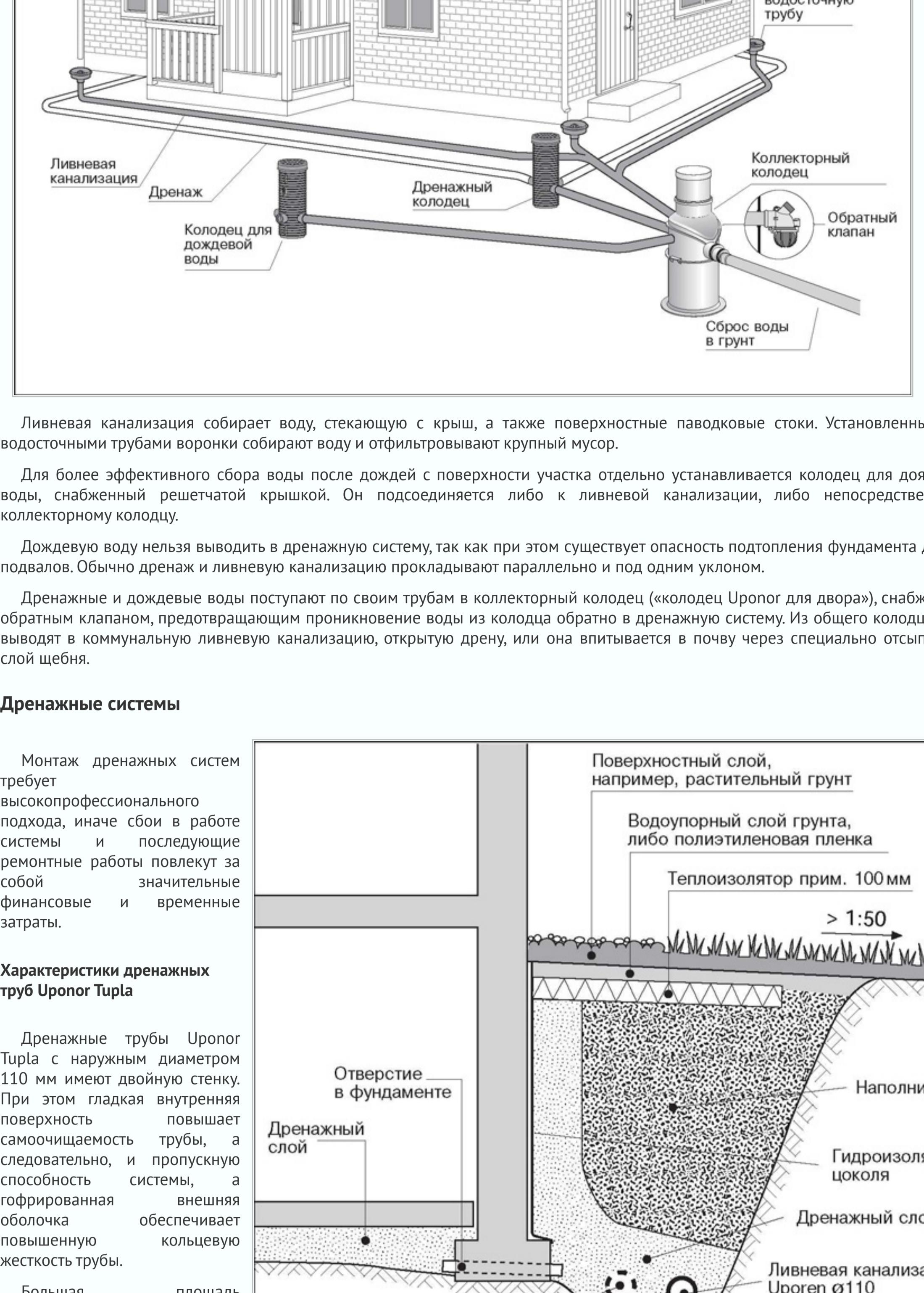
Ливневая канализация собирает воду, стекающую с крыши, а также поверхностные паводковые стоки. Установленные под водосточными трубами воронки собирают воду и отфильтровывают крупный мусор.
